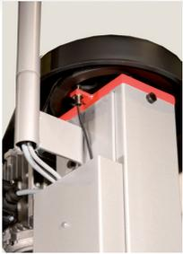
Sincronización electrónica mediante **autómata y detectores**.
