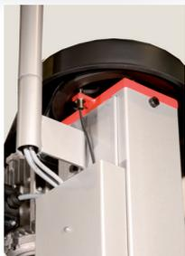
Sincronización electrónica mediante **autómata y detectores**.
