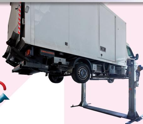
Los brazos simétricos (4 triples iguales) permiten elevar el vehículo en los **dos sentidos de posicionamiento del motor**. Esta **reversibilidad** le permite adaptarse a **cualquier espacio o tarea** sin preocuparse por la localización de la fuente de energía, luminosidad del taller, barreras arquitectónicas...
