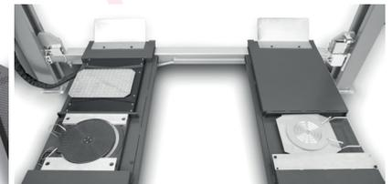
Prête pour encastrer à niveau des plaques tournantes ou d'alignement de 50 mm de hauteur. La passerelle comprend des barres d'aluminium pour des plaques tournantes petites.
