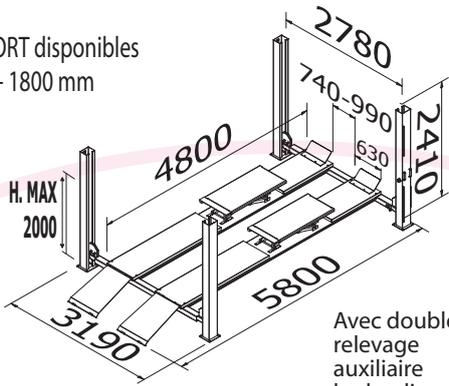
Avec double relevage auxiliaire hydraulique.
