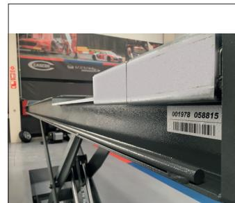
Equipé de série avec rail de guidage pour traverse de levage auxiliaire.
