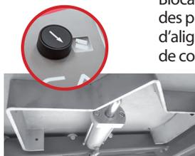
Blocage pneumatique des plaques d'alignement pour plus de confort.
