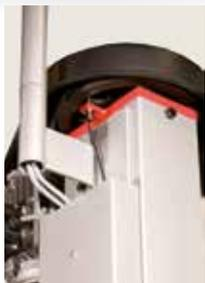
Synchronisation des colonnes par un automate programmable et par des détecteurs à induction.
