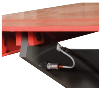
Photocellule protégée intégrée dans les ciseaux pour l'auto-nivellement des passerelles.
